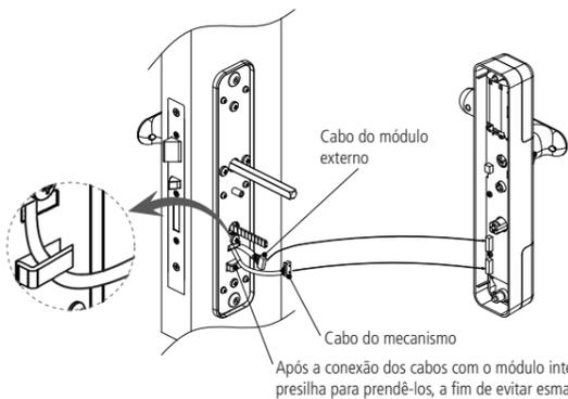
Após a conexão dos cabos com o módulo interno, utilize a presilha para prendê-los, a fim de evitar esmagamento
