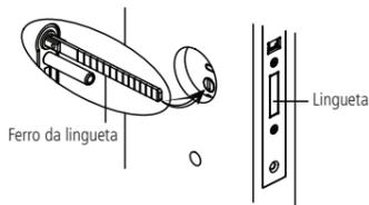
**Atenção:** após parafusar a unidade externa na chapa de fixação, gire o ferro da lingueta e veja se a lingueta trava e destrava facilmente. Caso não esteja funcionando corretamente, desaparafuse e encaixe novamente.
