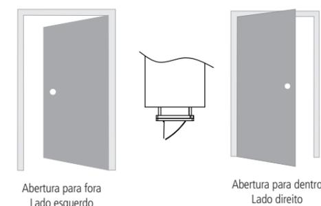
Para alterar a posição do trinco, mantenha pressionado o pino do sensor de fechamento até o fim do curso e altere a posição do trinco, conforme figura abaixo.
