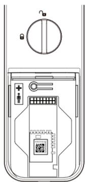
14. Fixe a unidade interna utilizando 3 parafusos A, conforme imagem a seguir. Insira também as 4 pilhas no produto (atenção à polaridade).
